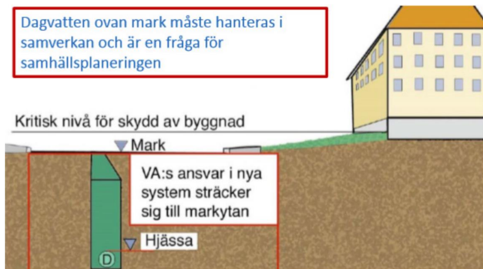
Figur 4.4.2 Dagvattenhanteringsens tre dimensioneringsnivåer Källa: P110
